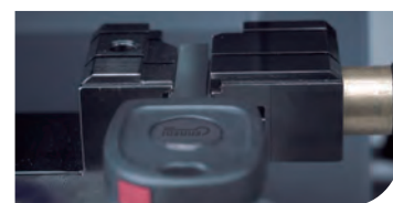
1 Direktes Einspannen von Schlüsseln der VAG ®-Gruppe Serrage direct de clés du groupe VAG ®
